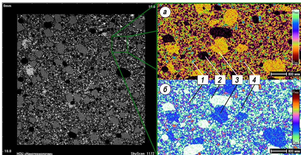
**Рисунок 2. Рентгеновские фотографии микроструктуры высокопрочного легкого бетона:**
