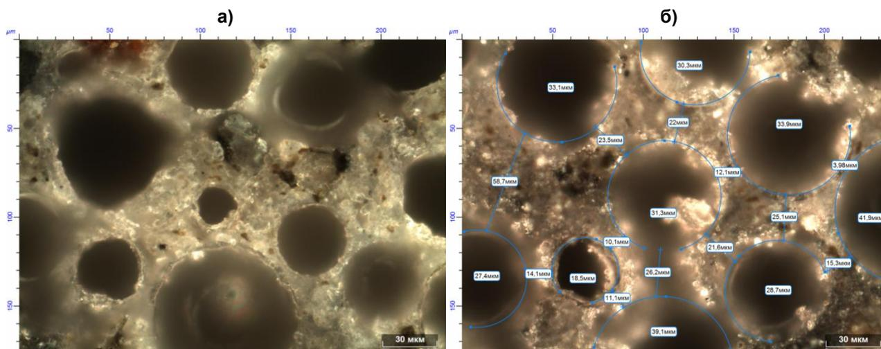
**Рисунок 1. Оптическая микрофотография структуры высокопрочного легкого бетона (увеличение 500х): а – средняя плотность бетона 1300 кг/м<sup>3</sup>; б – средняя плотность 1500 кг/м<sup>3</sup>**
