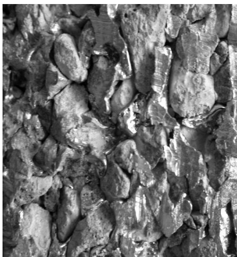
Рис. 3.34. Скол образца вариатропно-каркасного металлобетона
