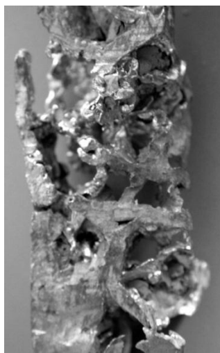
Рис. 3.35. Структура порового пространства металлобетона
