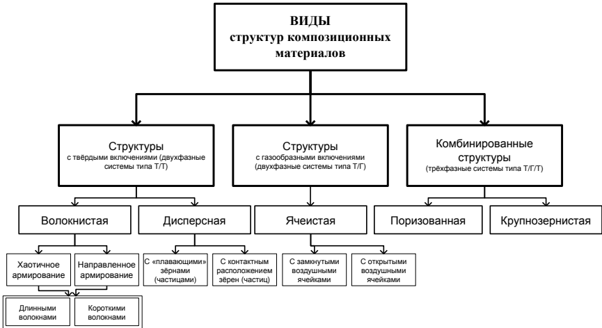
Рис. 2.6. Классификация видов структур композиционных строительных материалов ( T – твердая фаза; \Gamma – газовая фаза)
