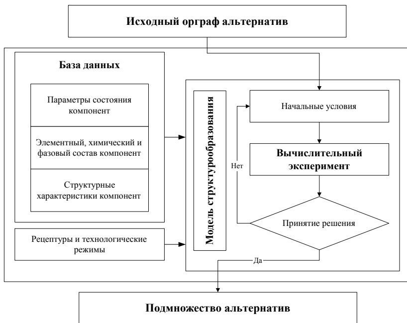
Рис. 3.1. Исходные данные и алгоритм моделирования
