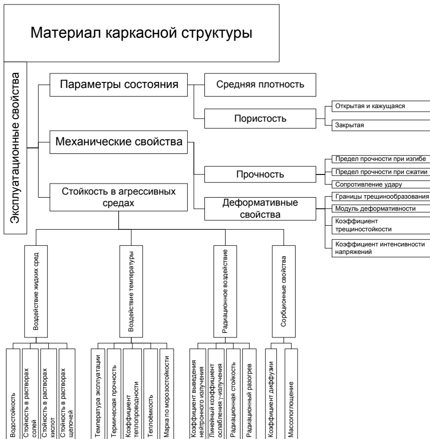
Рис. 2.11. Показатели качества материала вариатропно-каркасной структуры
