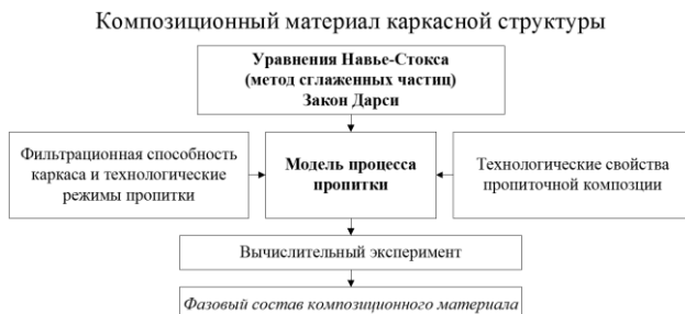
Рис. 3.10. Моделирование процесса пропитки
