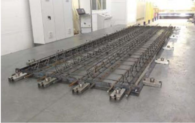
**Рис. 3.** Крупноформатный плоттер SMART PLOT с системой управления CAD–CAM наносит контуры с масштабом 1:1 до установки опалубочных систем и арматуры
