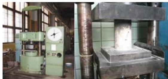
Пресс и лаборатория по испытанию бетона
