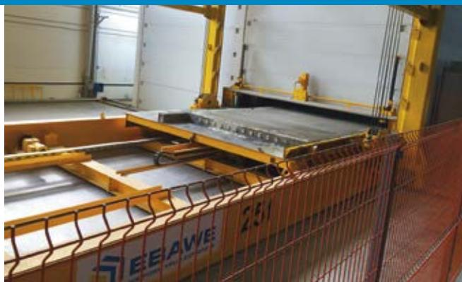
Паллеты со свежезабетонированными элементами поступают в комплекс стеллажей для сушки
