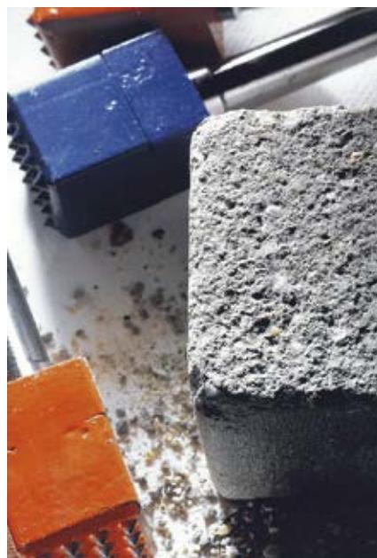
ких, закрепляемых под углом до 25°. В процессе керлинга снимается слой цемента, а открывшиеся частички породы полируются. Керлинг позволяет структурировать изделия, может придавать легкий блеск после дробеструйной обработки.
