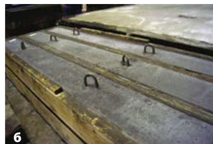
Рис. 4. Фотографии процесса изготовления изделий из высокопрочного легкого бетона (а — отформованное изделие, б — изделия после ТВО)
