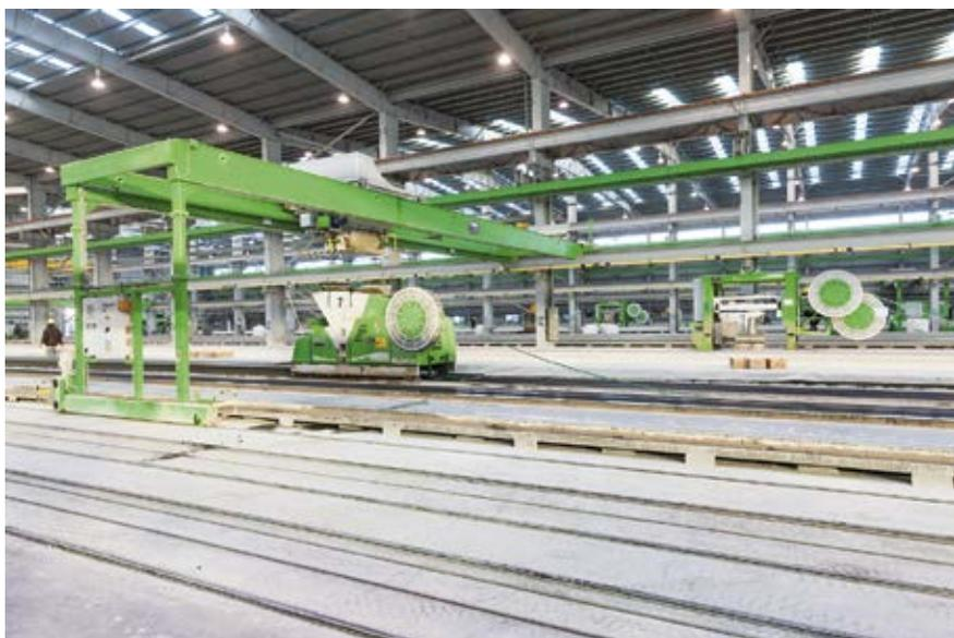
Конструкция экструдера и механизм уплотнения больше всего влияют на эффективность уплотнения при производстве многопустотных плит перекрытий.
