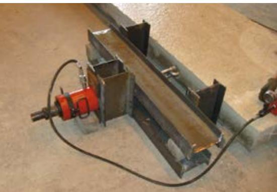
Общий вид испытания анкеров WAS36x380, установленных в панели толщиной 160 мм, с использованием проходного домкрата с усилием 50 т, насосной станции, стальных тяг с петлями и распределительной конструкции из двутавровых балок (усилие от упоров вне рабочей зоны анкера)
