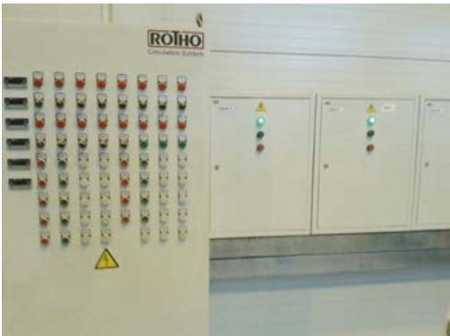
Посредством интеллектуальной системы управления с высокой точностью определяются температура и влажность в камере твердения
