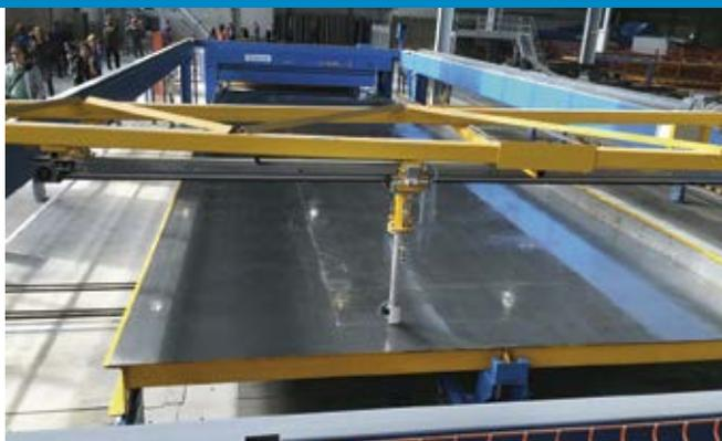
Плоттер наносит контур элемента
