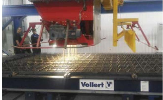
**Рис. 4.** Количество укладываемого бетона и скорость шипованного валька бетонораздатчика оптимально настраиваются под различную консистенцию бетона
