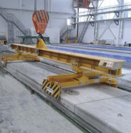
После резки, для транспортировки изделий используется специальный подъемный захват
