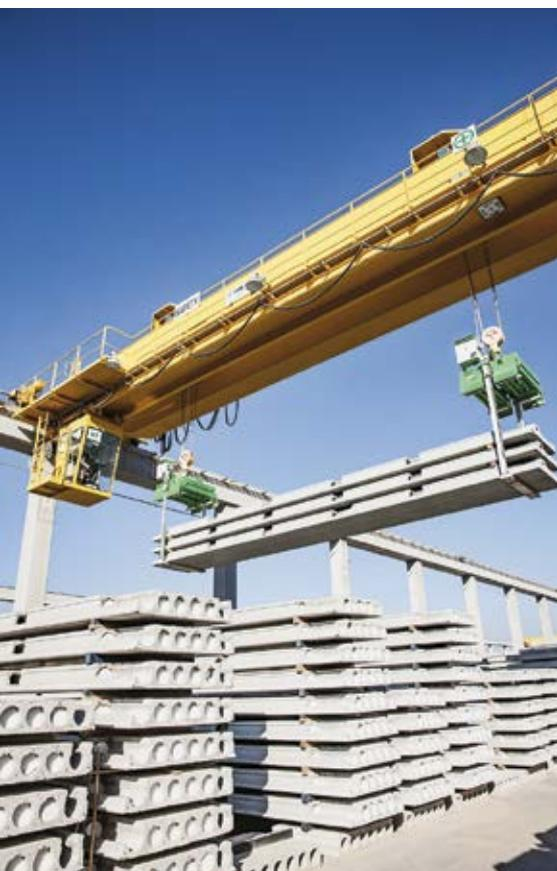
Стоимость устройства для подъема пучков многопустотных плит довольно низкая по сравнению с тем, как заметно оно повышает эффективность производственного процесса в целом
