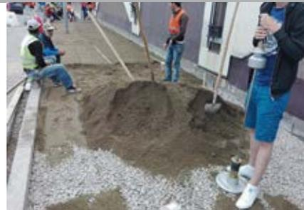
б) Испытания конструктивных слоев дорожной одежды
