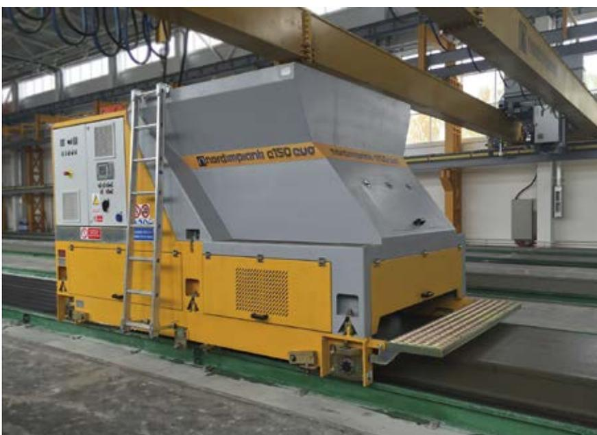
Экструдеры серии EVO компании NORDIMPIANTI — производство пустотных плит различных размеров; высоты варьируются от 150 до 520 мм, а ширина плиты может составлять 600, 1200, 1250, 1500 и 2400 мм
