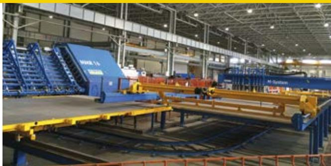
Сварочная автоматическая установка для сетки M-System Evolution
