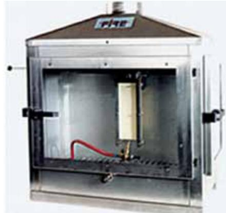
Рис. 3. Установка для испытаний по методу ГОСТ Р «Материалы строительные. Метод испытаний на возгораемость под воздействием малого пламени» («малая горелка»). Определяемые показатели: воспламенение фильтровальной бумаги горящим расплавом или частицами образца; наличие распространения пламени на расстояние 150 мм от точки его воздействия в течение 20 и 60 с
