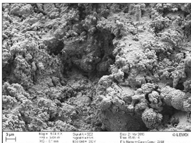
Рис. 3. Участок поверхности с напылением меди (увеличение 5,04 кХ)
