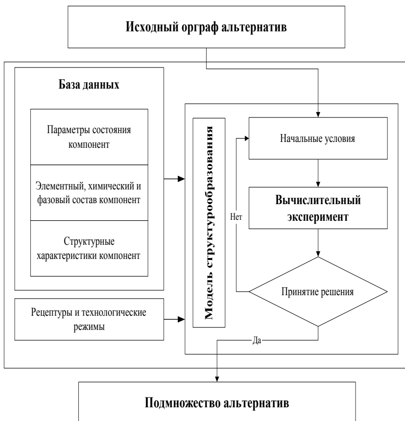
Рис. 3.1. Исходные данные и алгоритм моделирования
