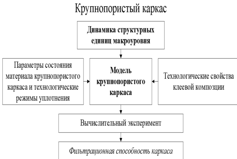
Рис. 3.9. Моделирование структуры крупнопористого каркаса
