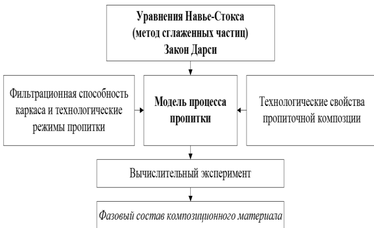
Рис. 3.10. Моделирование процесса пропитки
