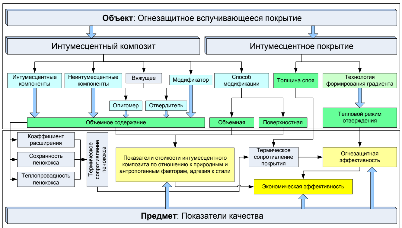
Рисунок 4 – Возможная декомпозиция одного из видов пассивной огнезащиты
