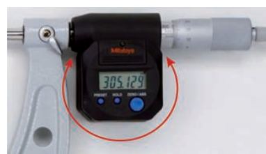
Дисплей поворачивается на 330°
